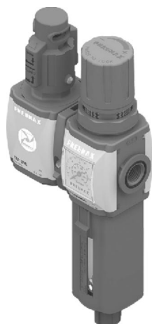
例如: GT171BVGG: 规格 1, 组件包括开关阀+过滤调压阀, 塑料螺纹, G1/4" 接口, 调压范围 0 至 8 bar, 20 μm 过滤精度.
